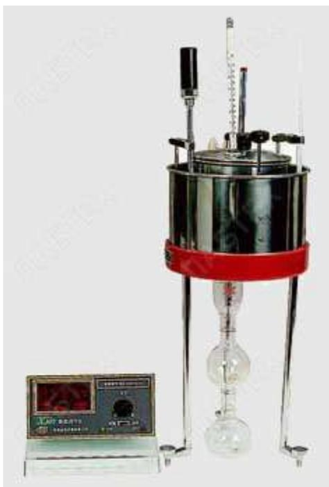
Вискозиметр ВУ-М (Лабтех) является аппаратом для определения условной вязкости жидких сред, дающих непрерывную струю в течение всего испытания и вязкость которых нельзя определить по ГОСТ 33.
