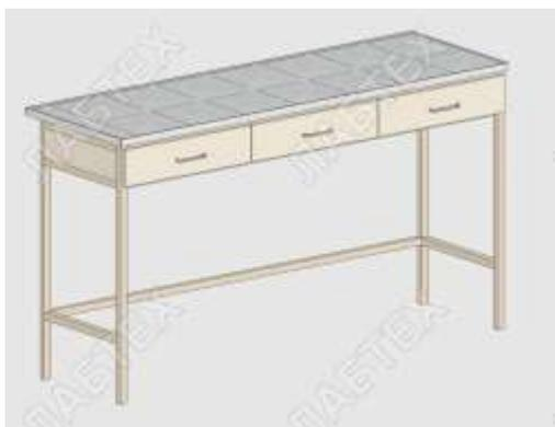
**Стол лабораторный ЛАБТЕХ-С-14** предназначен для работы с приборами, проведения химических, физических, биологических исследований, использования в медицине, бюро судебно-медицинских экспертизах и т.п. Каркас сварной из стальных труб. Обшивка, выдвижные ящики – из листовой стали. Могут комплектоваться раковиной, малой раковиной, смесителем, краном для газа. Опоры регулируются по высоте.
