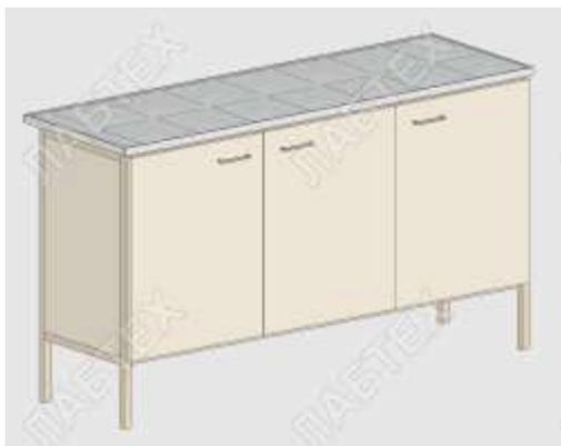
**Стол лабораторный ЛАБТЕХ-С-7** (1935 x 610 x 900) предназначен для работы с приборами, проведения химических, физических, биологических исследований, использования в медицине, бюро судебно-медицинских экспертизах и т.п. Каркас сварной из стальных труб. Обшивка, двери – из листовой стали, внутри – стальные полки. Могут комплектоваться раковиной, малой раковиной, смесителем, краном для газа. Опоры регулируются по высоте.
